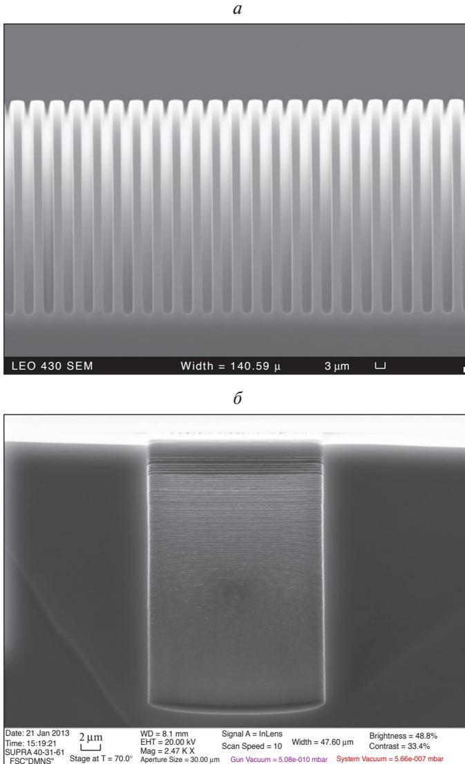
**Рис. 2.** РЭМ снимки канавочных структур шириной 3 мкм (*a*) и 20 мкм (*б*)
